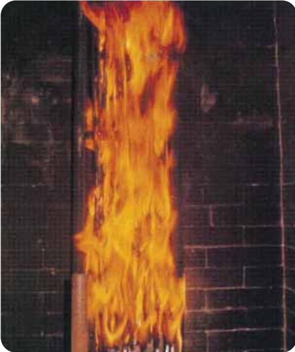
Alev iletme deneyinde standart PVC kablo
