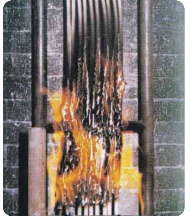
Alev iletme deneyinde AFUMEX™ kablo
